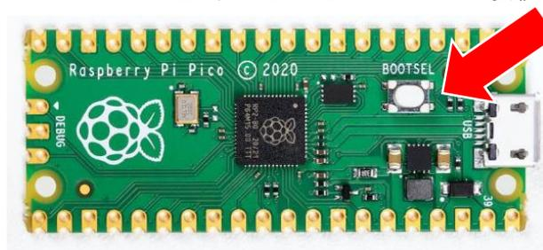
4. すると、USB メモリのような形でパソコン上から認識されるため、エクスプローラでそこを開き、rp2-pico-20210618-v1.16.uf2 をドラッグアンドドロップ
