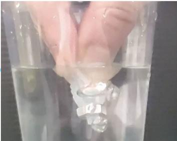
4. たれピンを、水面から尻尾が、5mm程度出るように調整して、浮かべます。
